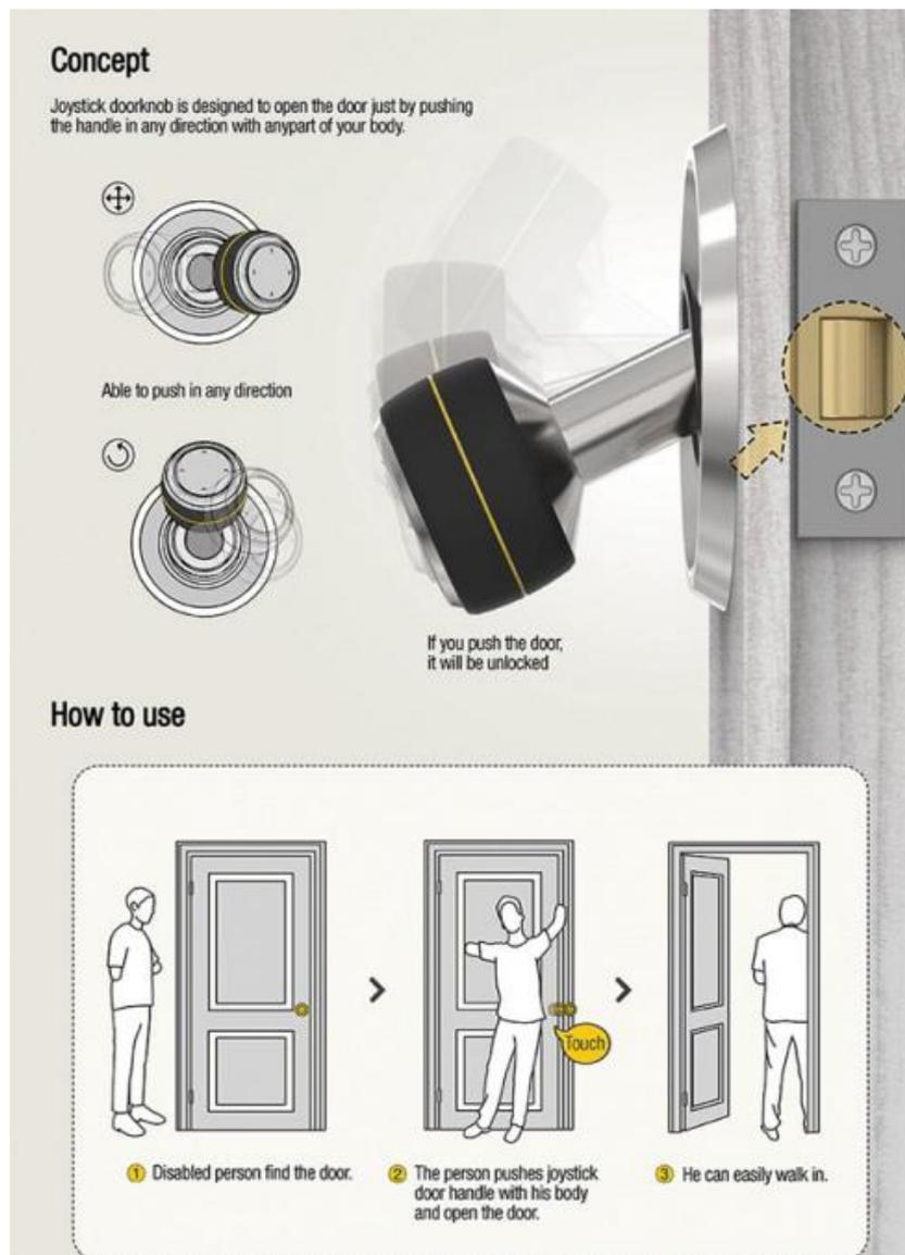
Figura 2 – 19 Modelo de maçaneta desenvolvido para pessoas sem as mãos e/ou com membros atrofiados. Fonte: Wordl Design Guide
